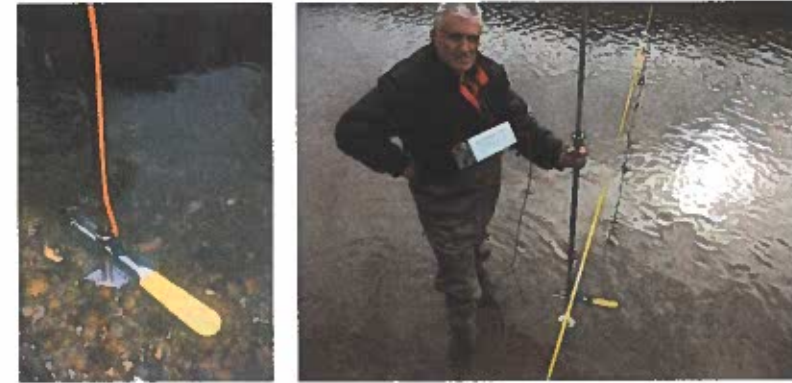
Slika 6.14. Elektromagnetna sonda za merenje brzina vode u otvorenim tokovima (fotografije: RHMZ).
