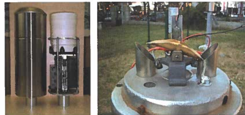
Slika 3.5. Kišomeri: težinski pluviograf (levo) i unutrašnjost pluviografa sa klackalicom (desno); fotografije: D. Pavlović.
