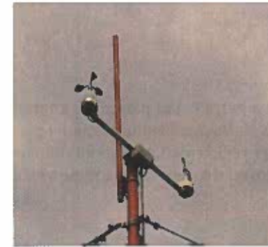
Slika 2.7. Instrumenti za merenje brzine vetra (levi instrument) i pravca vetra (desni instrument; fotografija: J. Plavšić).
