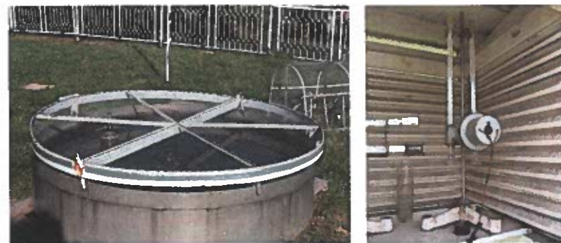
Slika 4.4. Isparitelj klase A u meteorološkom krugu (levo) i Pišov isparitelj u meteorološkom zaklonu (desno) ispred RHMZ-a u Košutnjaku u Beogradu (desno; fotografije: J. Plavšić).
