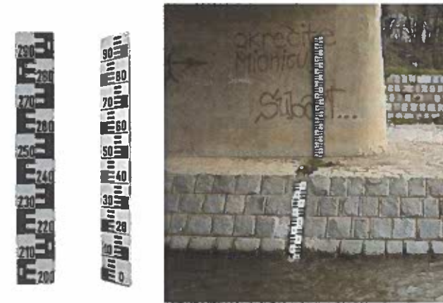
Slika 6.10. Vodomerna letva kao uređaj za merenje vodostaja. Na desnoj slici su prikazane kosa i vertikalna vodomerna letva na hidrološkoj stanici Mionica na reci Ribnici.
