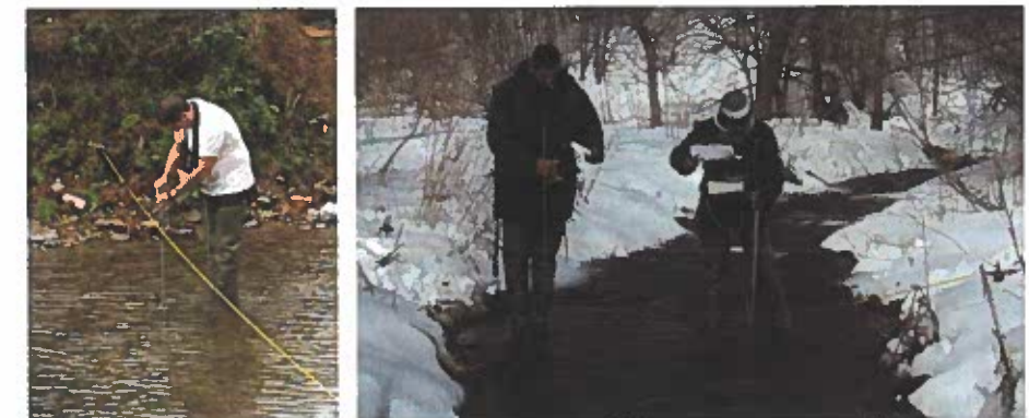
Slika 6.15. Merenje brzina na malim vodotokovima u koje se može zagaziti (fotografije: RHMZ).
