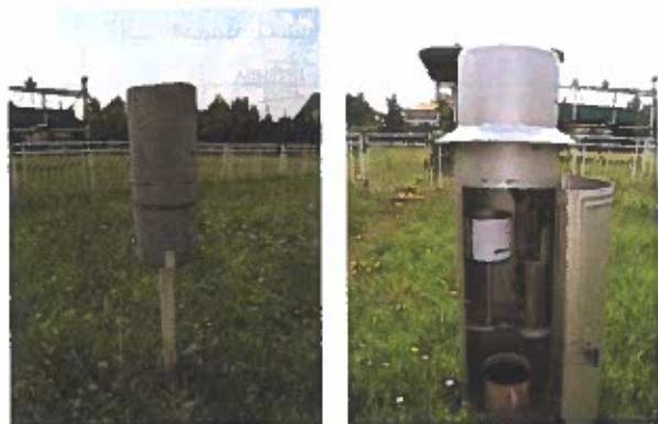
Slika 3.4. Kišomeri: neregistrujući (levo) i registrujući sa plovkom i papirnom trakom (desno); fotografije: J. Plavšić.
